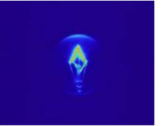
電球ガラス越し計測
